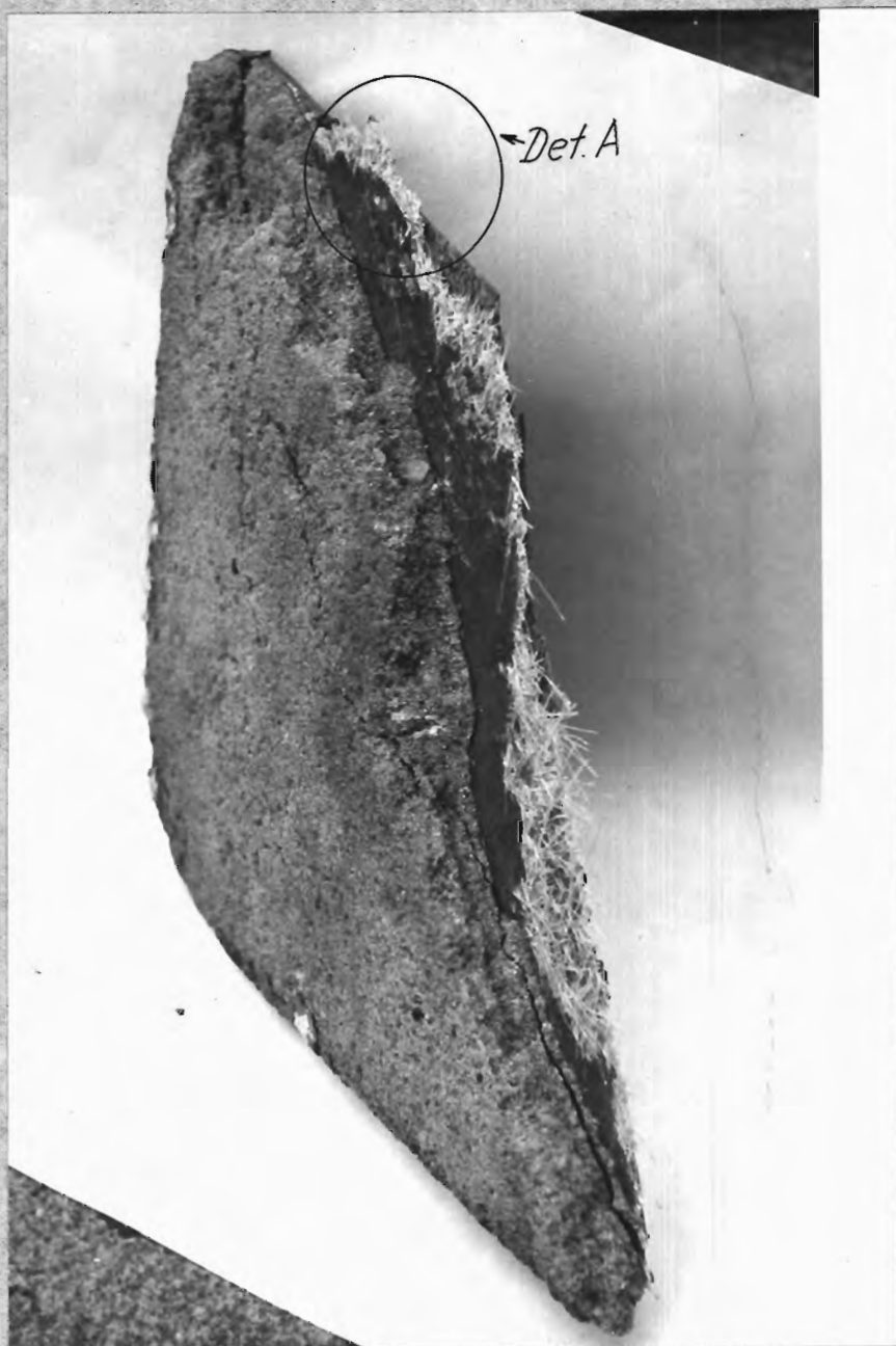
Obr. 11 : Skladba krytiny hřiště s dobře patrnou spárou oddělující spodní plastbetonovou od vrchní laminované části
