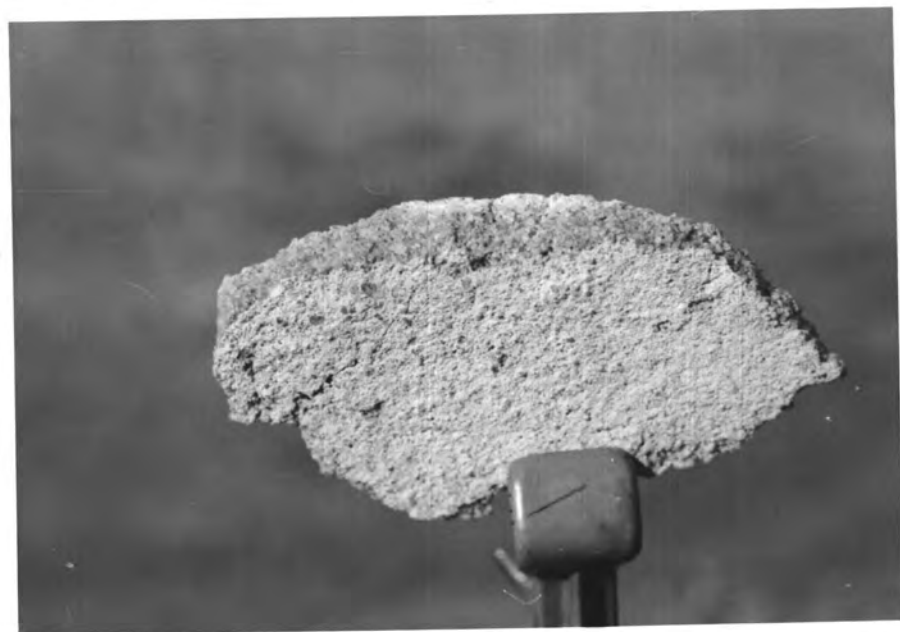
Obr. 9 - Vzorek podlahoviny z haly 1 (s pohledem na rub)
