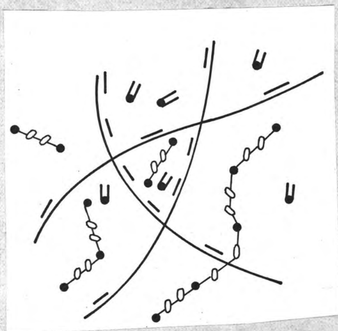
Obr. 21 b Zcela inhibovaná a oxidovaná /nestvrdlá/ polyesterová pryskyřice
