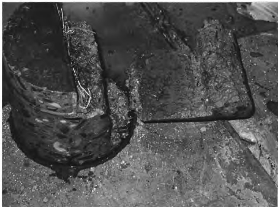
Obr. 12 Vývrt přes dilatační a pracovní spáru 5 v poli GH Obr. 13 Pokles vývrtu po odstranění vrtáku o cca 10 mm
