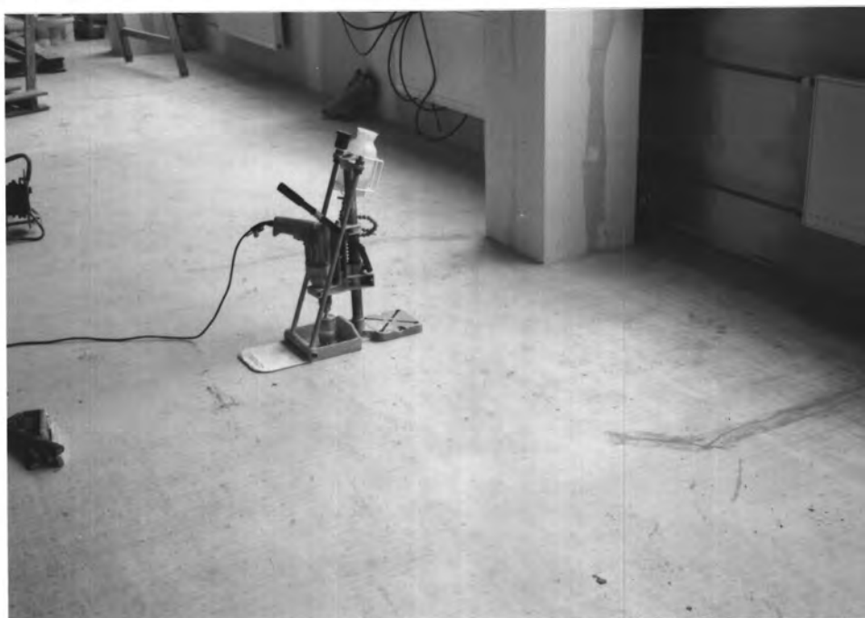
obr. 10 – Zařízení k vývrtům COMTEST OP/P2
