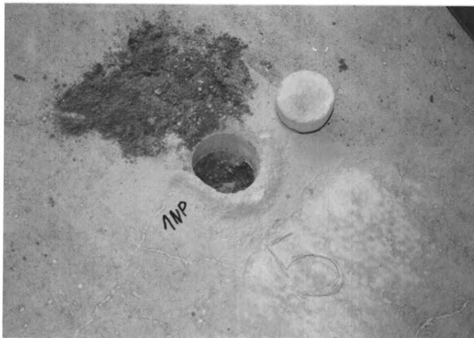
obr. 9 - Jeden z vývrtů celou podlahou se zcela rozvolněnou vrstvou pěnobetonu
