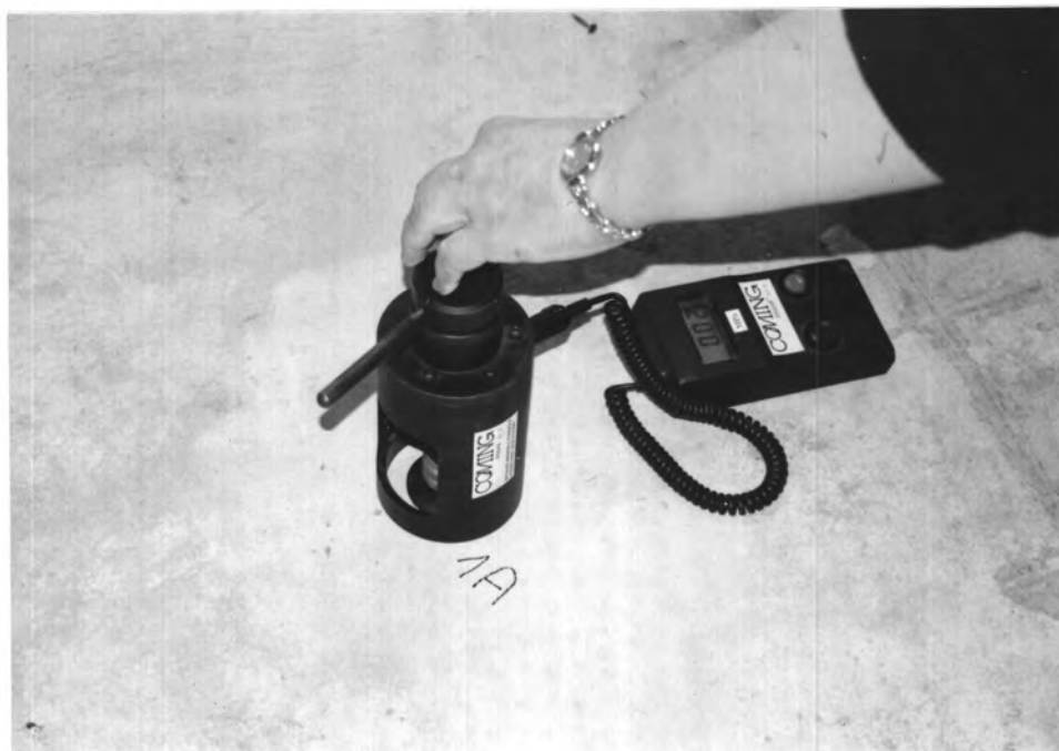
obr. 1 – Odtrhová zkouška přístrojem COMTEST OP 1
